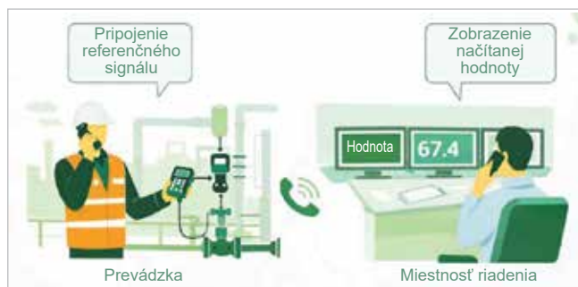
Obr. 2 Typické nastavenie kalibrácie slučky, kde sa referenčný signál aplikuje v prevádzke a výsledná hodnota sa pozoruje v riadiacej miestnosti
