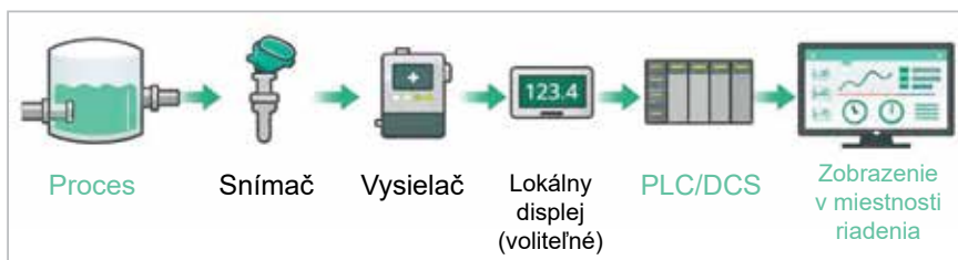
Obr. 1 Príklad meracej slučky začínajúcej sa na procesnom snímači a končiacej sa na konečných hodnotách zobrazených na displeji v riadiacej miestnosti
